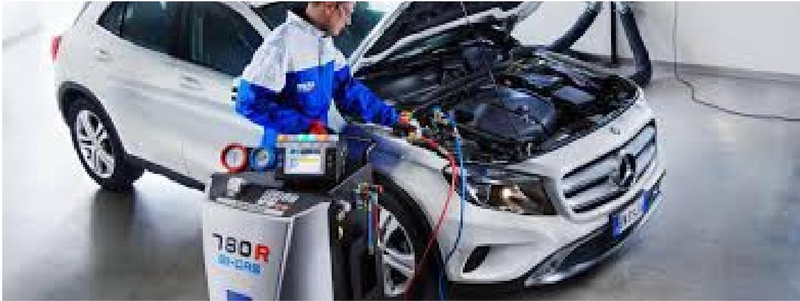
STRUMENTI AGGIORNATI PER REPARAZIONE E MANUTENZIONE IMPIANTI DI CLIMATIZZAZIONE CON GAS R134 E R1234YF
